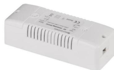
**SSD13300 es un driver dimable**, para LED luminarias con intensidad de salida 300mA DC. Se puede gestionar con cualquier RF mando a distancia o RF dimer para caja de mecanismos de la serie 2.4G SMART. Apagando la alimentación eléctrica, el driver memoriza su ultimo modo, después del encendido de la corriente eléctrica se queda en el mismo nivel de intensidad lumínica. Compatible con LED downlights de luz indirecta **Ultralux 8W y 12W – ILDR8xx, ILDR12xx, ILDS8xx, ILDS12xx.**
